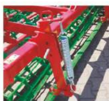
Przednia wółka regulowana zabezpieczeniem sprężynowym
