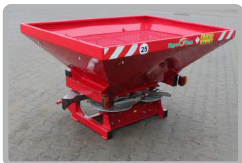
Dwie tarcze kwasoodporne z regulowanymi łopatkami
