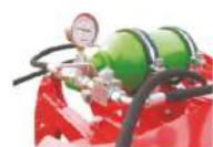
Układ hydrauliczny głębosza GHL (zawór odcinający, manometr, akumulator hydropneumatyczny)
