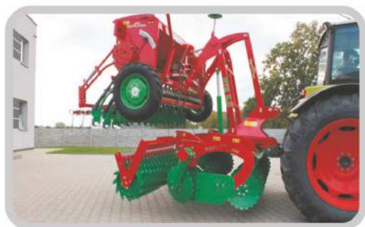
Piasty bezobsługowe z uszczelnieniem kasetowym
