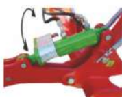
Siłownik hydraulicznej regulacji głębokości pracy agregatu GTH XL
