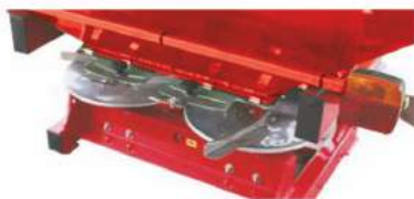
Dwie tarcze kwasoodporne z regulowanymi łopatkami
