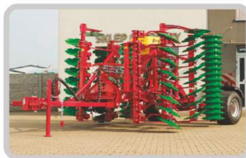
Siłownik hydraulicznej regulacji głębokości pracy agregatu
