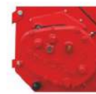
Bezstopniowa przekładnia napędu aparatów wysiewających
