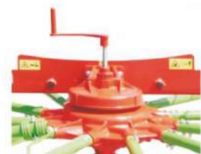
Śruba regulująca wysokość położenia ramion zgrabiarki
