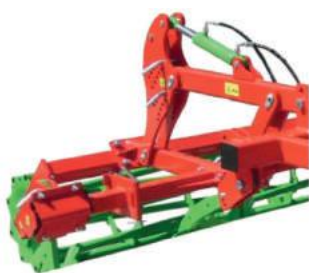
Hydrauliczna oraz punktowa regulacja położenia wału
