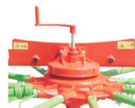
Śruba regulująca wysokość położenia ramion zgrabiarki
