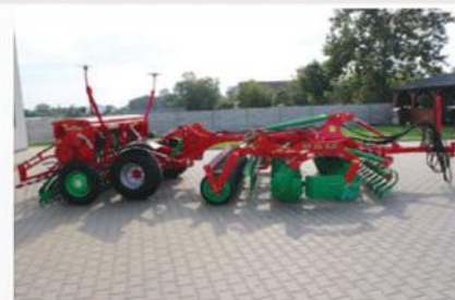
Agregat talerzowy AT XL z wózkiem i sprzęgiem do siewnika + siewnik PSR
