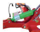
Siłownik hydraulicznej regulacji głębokości pracy aparatu
