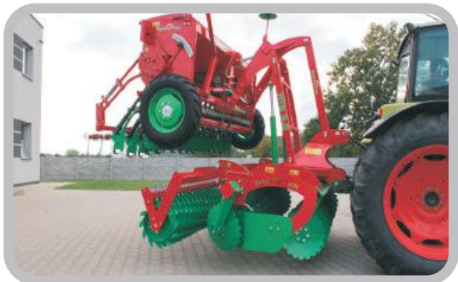
Piasty bezobsługowe z uszczelnieniem kasetowym
