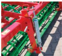
Przednia włoka regulowana zabezpieczeniem sprężynowym
