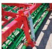
Przednia włoka regulowana zabezpieczeniem sprężynowym
